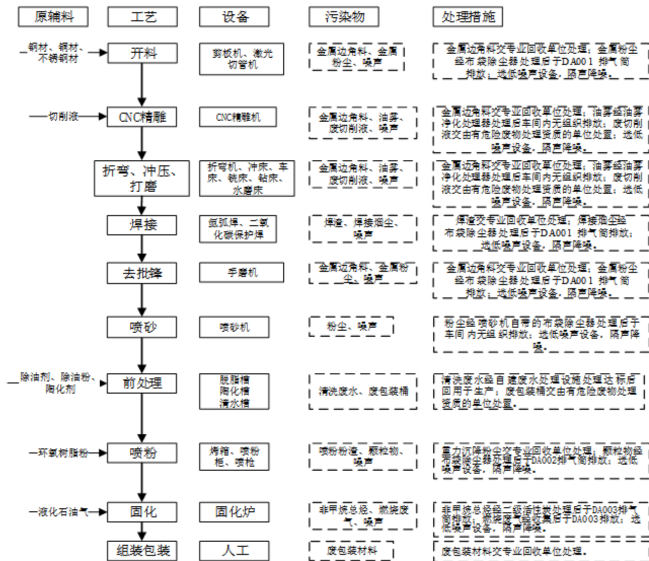
图 2-4 项目生产工艺流程及产污节点图
