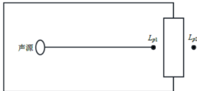
图 4-7 室内声源等效为室外声源图例
