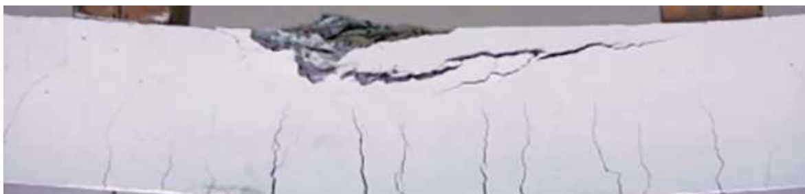
出现超过梁高 2/3 的竖向裂缝
